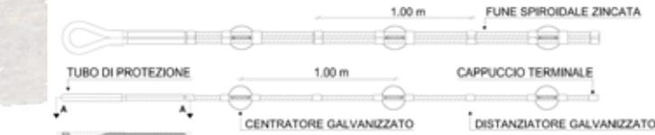
Progetto di ancoraggio di rete fermaeve in doppia fune spiridale metallica
