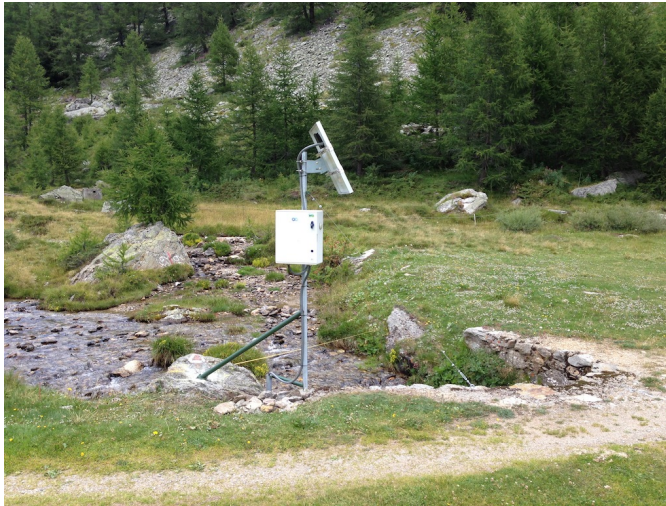
Figura 1.1: Esempio di stazione idrometrica installata su torrente
