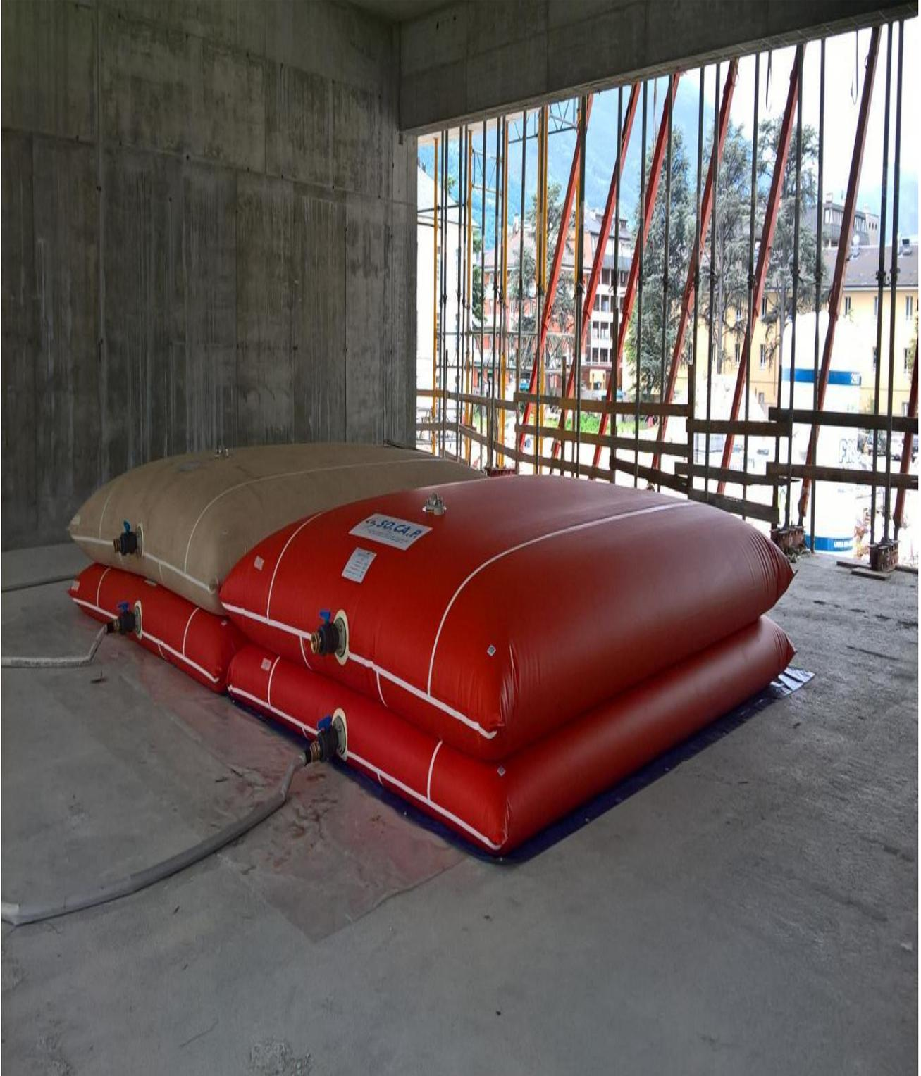
Mediante il posizionamento di materassi ad acqua (o carichi equivalenti) e opportuna strumentazione di lettura degli spostamenti con precisione 1/100 mm (LVDT) è possibile effettuare prove statiche di collaudo o verifica di capacità portante.
