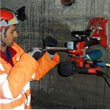
Per la determinazione delle caratteristiche di resistenza meccanica del cls in situ è possibile estrarre delle carote cilindriche per la preparazione di provini da testare in laboratorio mediante prove di compressione.
