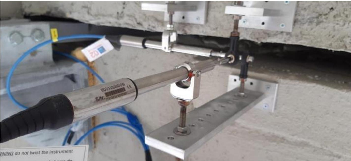
Mediante l'installazione di sensori di spostamento a tecnologia LVDT è possibile eseguire l'evoluzione di spostamenti relativi con la precisione del millesimo di millimetro.
