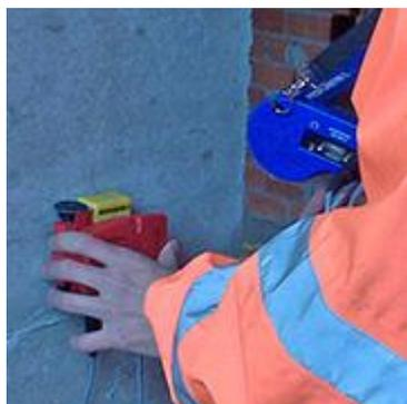
La pacometria è un metodo non distruttivo e non invasivo in grado di fornire informazioni di tipo quantitativo in ordine alla posizione delle barre metalliche, alla loro profondità e al loro diametro.
