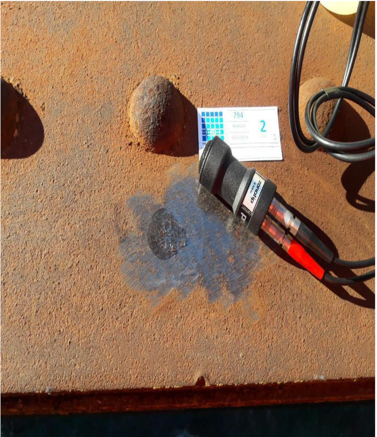
La valutazione delle caratteristiche meccaniche degli acciai da carpenteria può essere effettuata rapidamente mediante durometro LEEB portatile.
