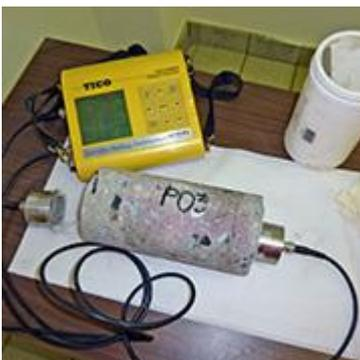
Mediante l'impiego di onde ultrasonore è possibile indagare la parte interna di una struttura in calcestruzzo.
